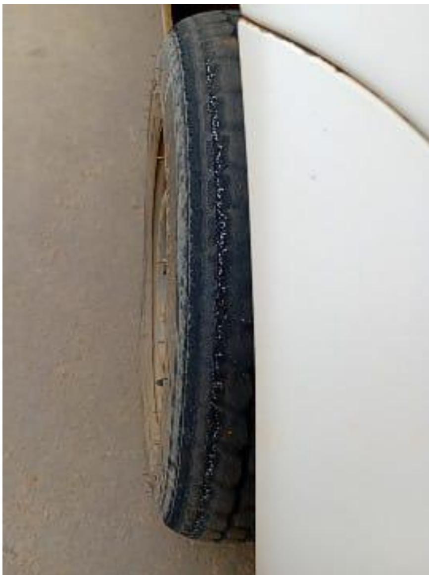
1. registro mostrando a condição precária do pneu de um veículo da municipalidade
