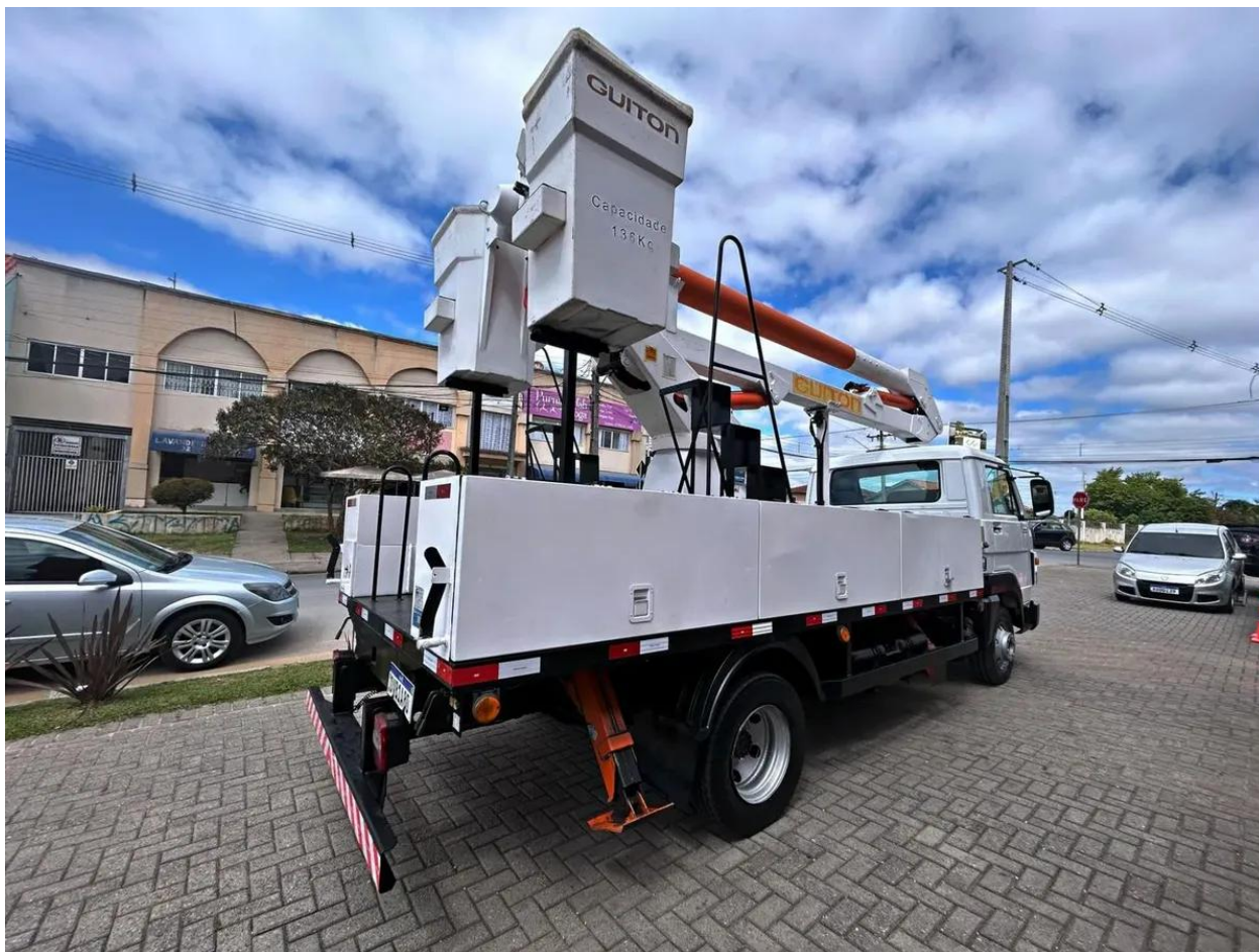
1. Modelo de caminhão Munck para a substituição de lâmpadas e outros serviços
